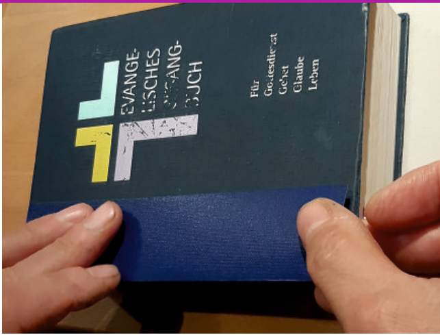
Der Umschlag wird mit einem stabilen Fälzelband geklebt.
