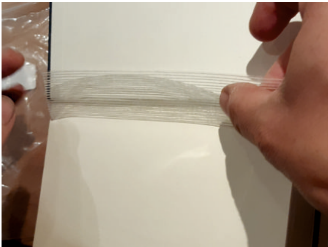
Der Buchblock erhält ein glasfaserverstärktes, durchsichtiges Band zur Stabilisierung.
